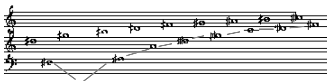
figure III-5 : hauteurs produites par une modulation de fréquence de Fa#3 par Sol#2 avec des phénomènes de repliement.
